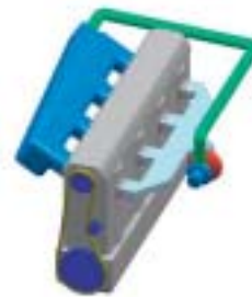
Indirekte Ladeluftkühlung / Ansaugkrümmer mit integriertem LLK
